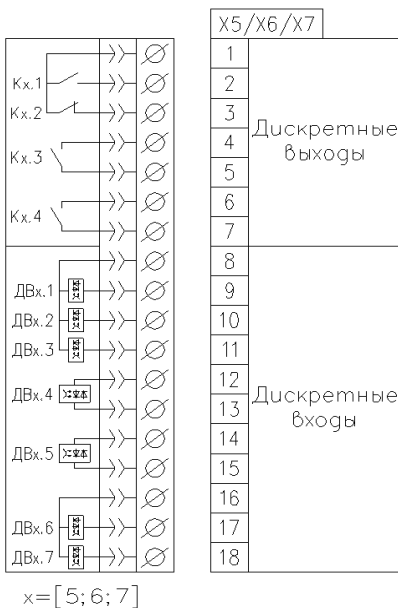
Рисунок 3.1 – Конфигурация разъемов дополнительных дискретных входов и выходов
